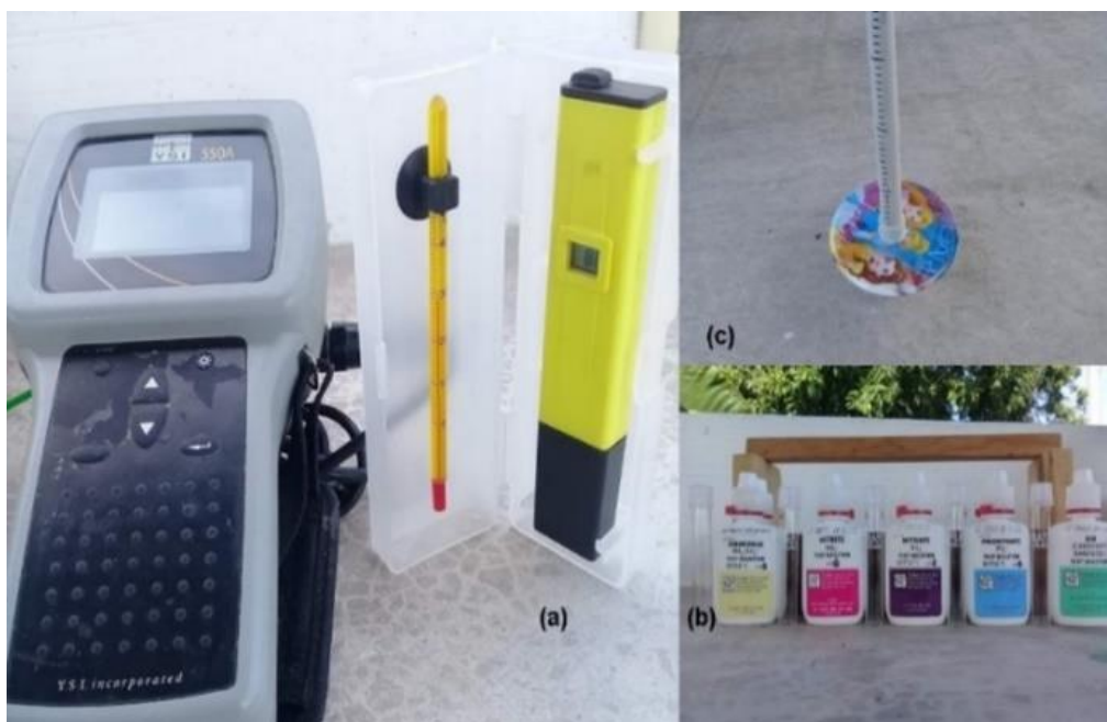
Figura 5. (a) Oxímetro digital, termómetro y medidor de pH, (b) Reactivos químicos para el análisis del agua, (c) Disco de Secchi para medir la transparencia.
