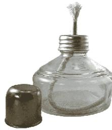
El mechero Bunsen se puede construir de forma casera con cualquier frasco, un cordón de algodón que sobresalga de la tapa y alcohol al 70 %.
