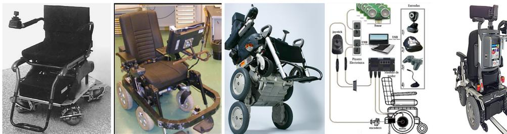
Figura 2. Silla de ruedas omni-direccional [1]; Figura 3. Silla de Ruedas Vahm-3 [7];
