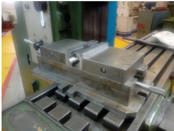
Figura 2. Prensa fabricada con placas y armada con tornillos y pernos localizadores.
