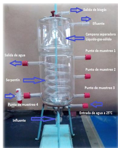
Fig. 2. Reactor tipo RALLFA<sup>[21]</sup>
