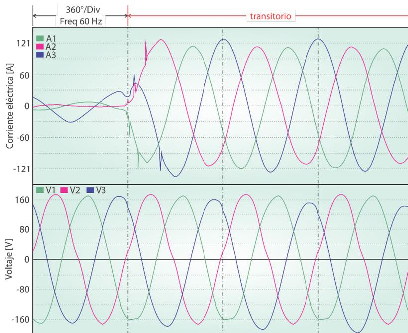
Figura 3. Corriente y voltaje registrados en el instante en que se presenta el transitorio por el arranque del compresor.
